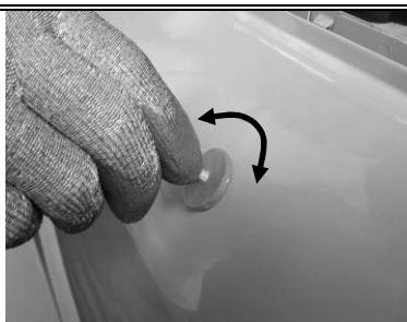
**FR** Placer l'embout sur la zone à débosseler. Effectuer quelques mouvements de rotation (droite/gauche) pour éliminer les bulles d'air. Attendre 2 minutes, le temps que la colle sèche.
