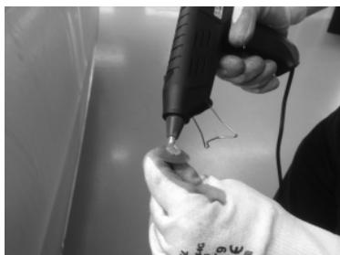
**FR** Choisir l'embout adaptée à la dimension de la zone à débosseler : Ø32 – Ø20 – Ø15mm. S'assurer que l'embout soit propre. Déposer généreusement la colle sur l'embout.
